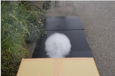
打ち出し直後、直径約30cmのドーナツ状構造がはっきりわかります。
